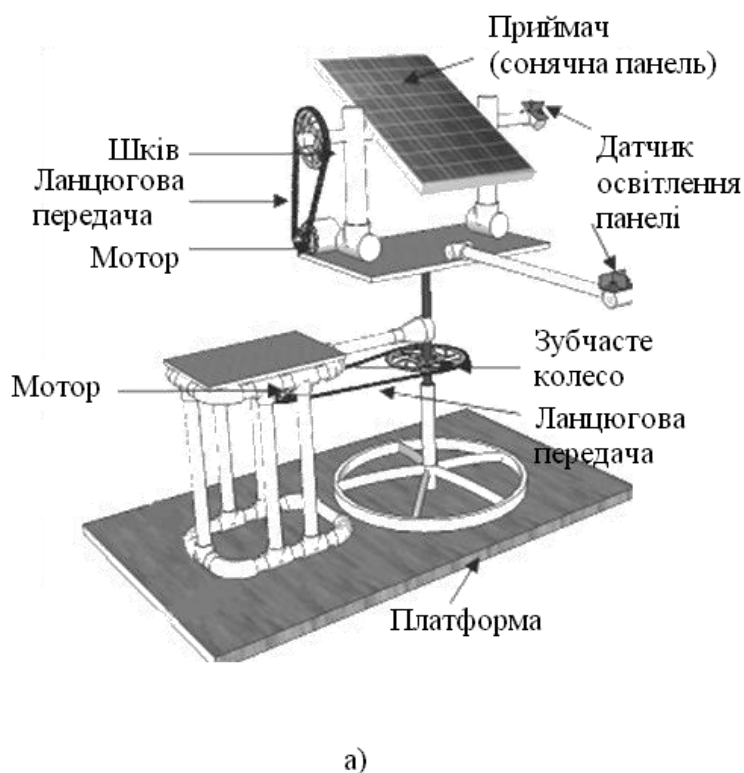
Рис.1. Принципова конструкція двовісного трекеру (а) та приклад геліостанції з похилим розташуванням сонячних панелей і одновісним трекером (б)
