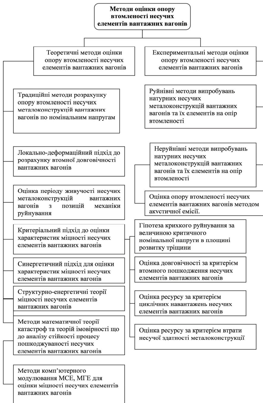
Рис. 2 -Класифікація методів розрахунку опору втомленості несучих металоконструкцій вантажних вагонів
