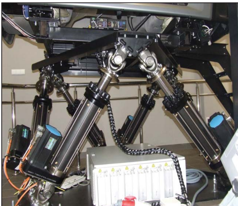
Rys. 2. Platforma nośna kabiny pojazdu o 6-ciu stopniach swobody
