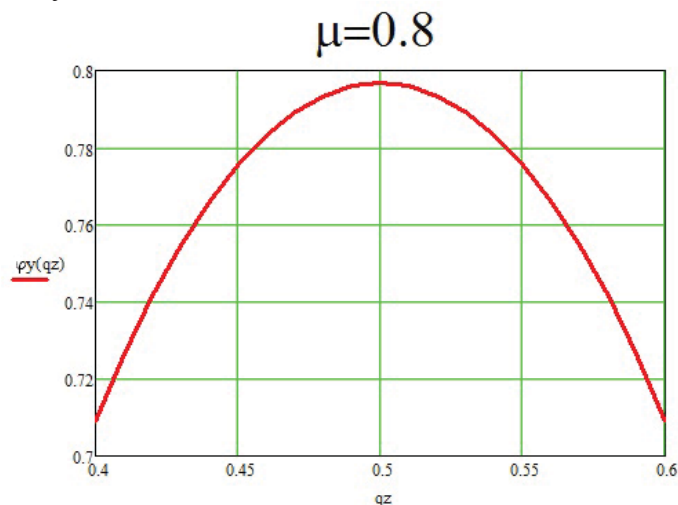
На рис. 3 График зависимости коэффициент распределения суммарной нормальной нагрузки внутреннего колеса q_z от бокового коэффициентами сцепления \varphi_y
