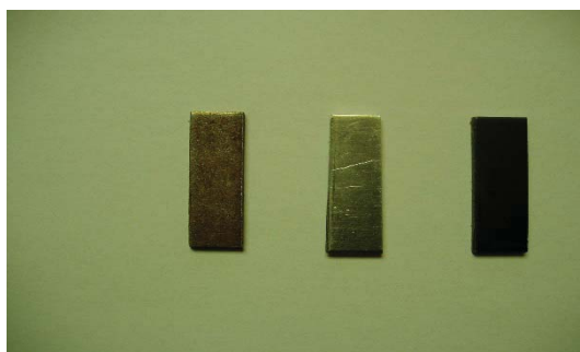
Рисунок 1. — Вплив штатного дизельного палива на досліджувані зразки матеріалів
