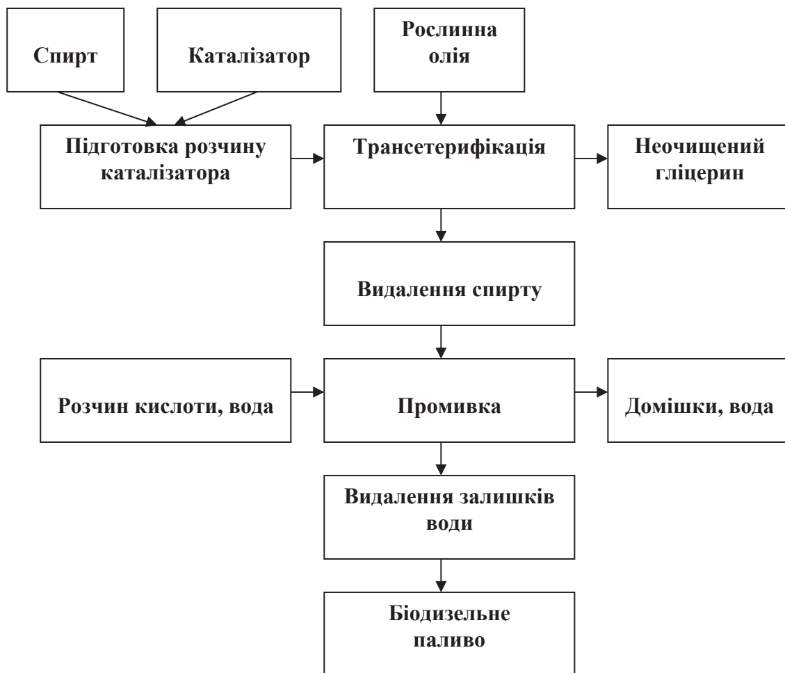
Рисунок 1. – Принципова схема процесу трансетерифікації
