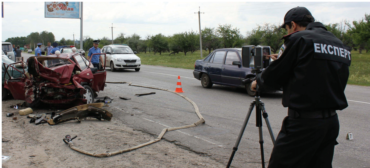
Рисунок 2 – Лазерне сканування ділянки дороги експертом-автотехніком під час огляду місця ДТП
