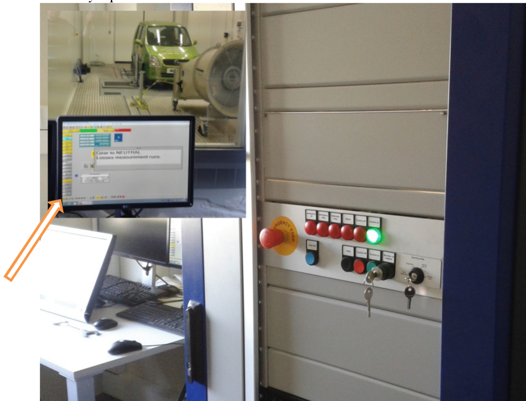
Rys. 2. Widok sterowni z komputerami sterującymi pracą hamowni podwoziowej
