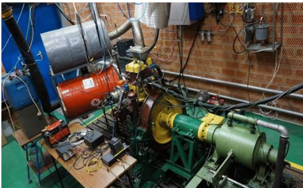
Rys. 3. Obiekt badań – jednocylindrowy silnik badawczy SB-3.1 wyposażony w układ zasilania typu CR [9]
