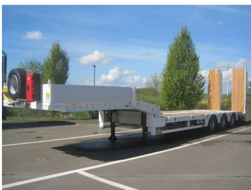
Rys. 3. Naczepa o obniżonej platformie [3]
