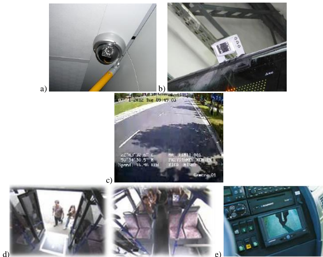
Rys. 6. System monitoringu mobilnego autobusu: a) widok kamery wewnątrz autobusu, b) widok kamery zewnętrznej, c) obraz przed autobusem z kamery umieszczonej z przodu autobusu [11], d) widok z kamery wewnątrz autobusu, e) obraz z kamery widoczny na panelu kierowcy [2]
