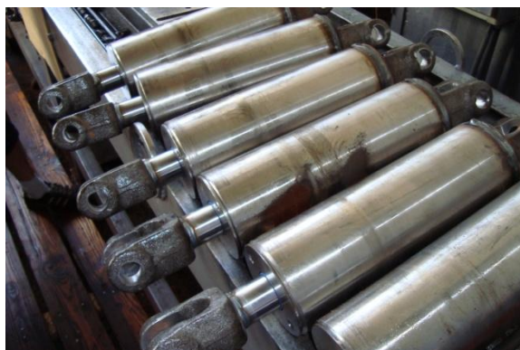
Рисунок 7 – Гідроциліндри Ц-100, виготовлені з використанням деформуюче-різального протягування
