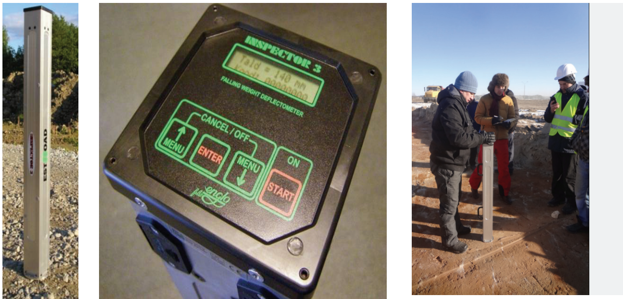
Рисунок 2 – Прилад для визначення динамічного модуля пружності Inspector 3
