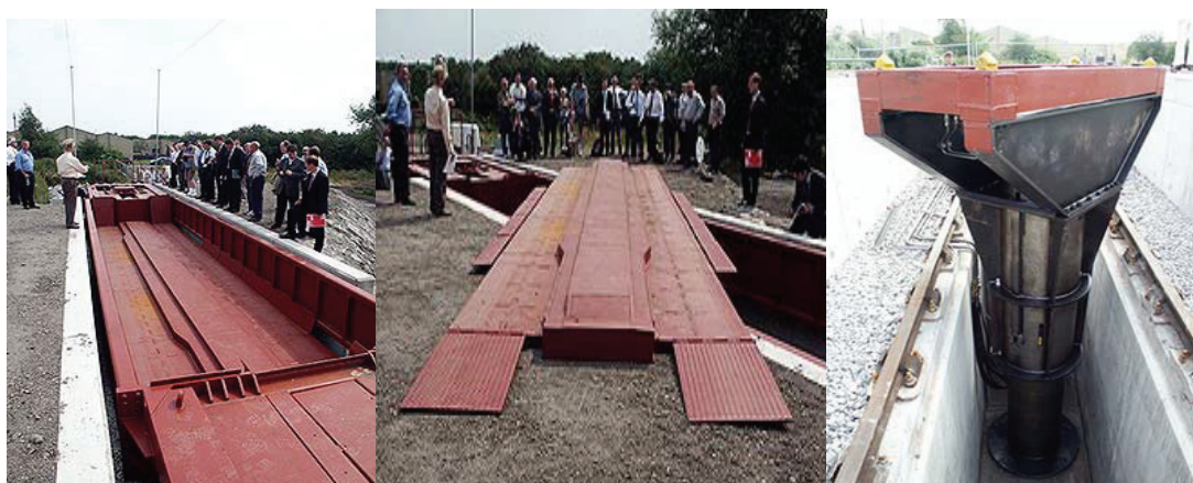
Рисунок 4 – Система CargoSpeed, платформа wellfloor та підйомний механізм
