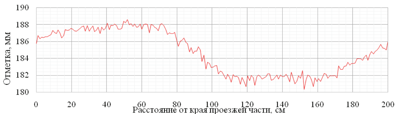
Рисунок 22– Пример записи результатов сканирования профиля поверхности дорожного покрытия
