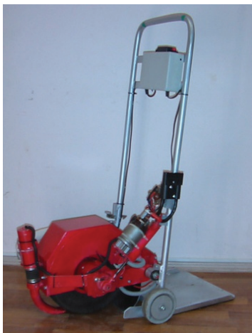
Рисунок 23– Портативный прибор НТУ для измерения коэффициента сцепления автомобильных дорог и тротуаров
