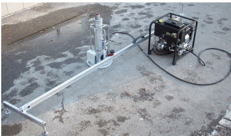
Рисунок 18 – Станция для штамповых испытаний дорожных конструкций и их слоев
