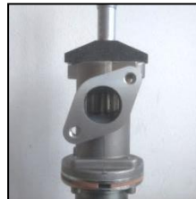
Rys.2. Pomiar otwarcia zaworu EGR
