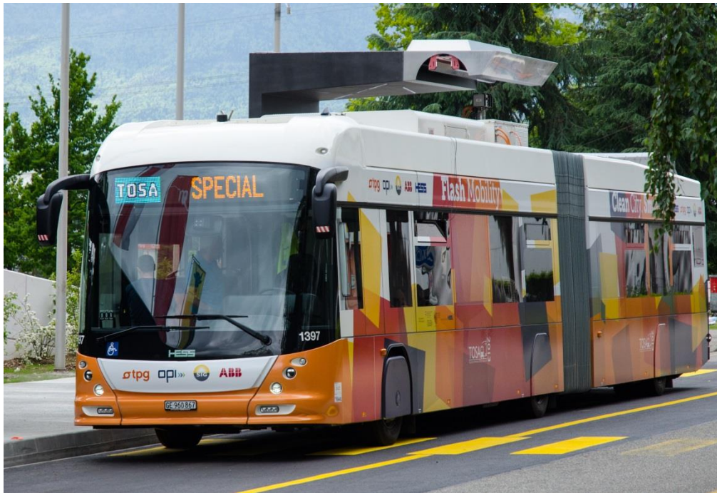
Rys. 1. Widok autobusu z systemem szybkiego ładowania na przystankach grupy ABB [5]
