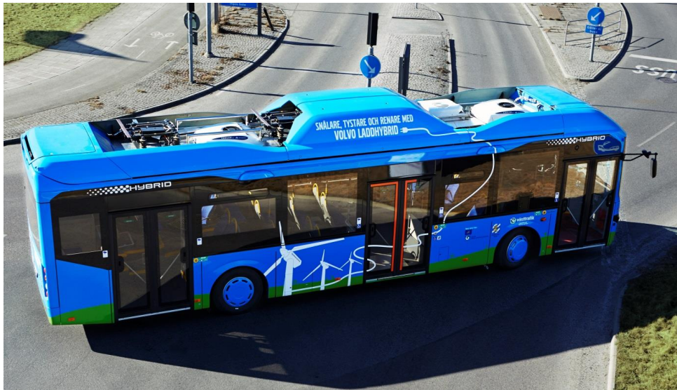
Rys. 5. Autobus szybko ładowany na przystankach autobusowych przez automatyczny system połączeń montowany na dachu autobusu ACS (Automatic Roof-Top Connection System)[2, 5]
