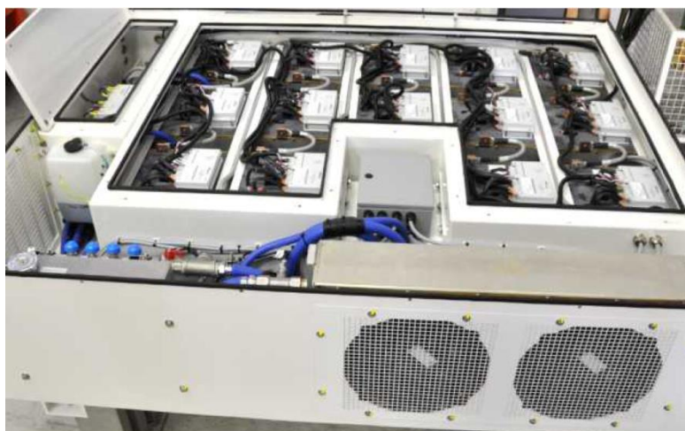
Rys. 4. Zespół 14 baterii LTO (Lithium Titanate Oxide) połączonych szeregowo, chłodzonych wodą, o pojemności energetycznej 38 kW·h. [5]
