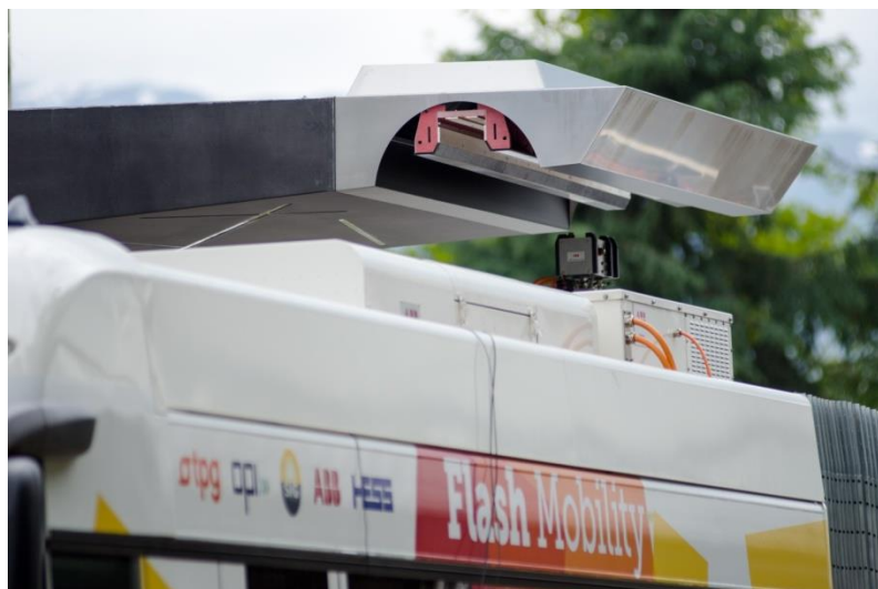
Rys. 2. System grupy ABB wykorzystuje laser do sterowania ruchomego ramienia, które łączy się z górnym gniazdem do ładowania na przystankach autobusowych [5]
