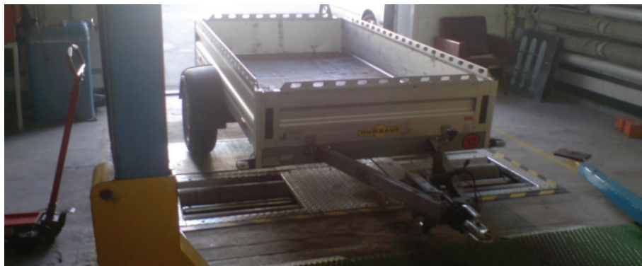
Рисунок 5 - Загальний вигляд гальмівного стенда ERBT-3.6 і причепа Humbaур 1385
