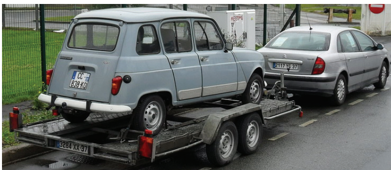
Рисунок 1 – Легковий автопотяг з причепом, який обладнаний інерційною гальмівною системою
