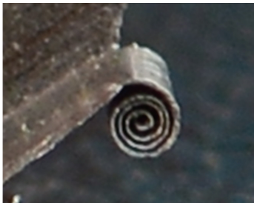
Рисунок 4 – Фрагменти стружкоутворення при вільному ортогональному різанні сталі 12Х15Г9НД (AISI 201), зміцненої по схемі поперечного стиску з деформацією 44,3%, у середовищі ріпакової оливи (а) та сульфозфрезолу Р (б). х 5
