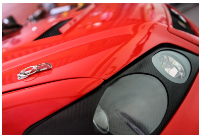
Rys. 8. Nowy kształt lampy: a) forma, b) gotowa lampa z włókna węglowego
