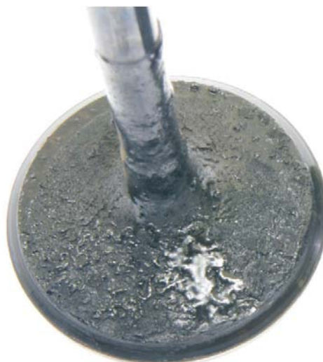
Rys.8. Osady na zaworze dolotowym silnika zasilanego paliwem E85 [4]
