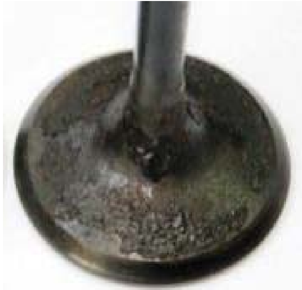
Rys.3. Osady utworzone na zaworze dolotowym [3]
