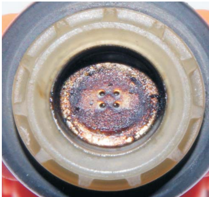
Rys.5. Osady utworzone na końcówkach wtryskiwaczy [4]
