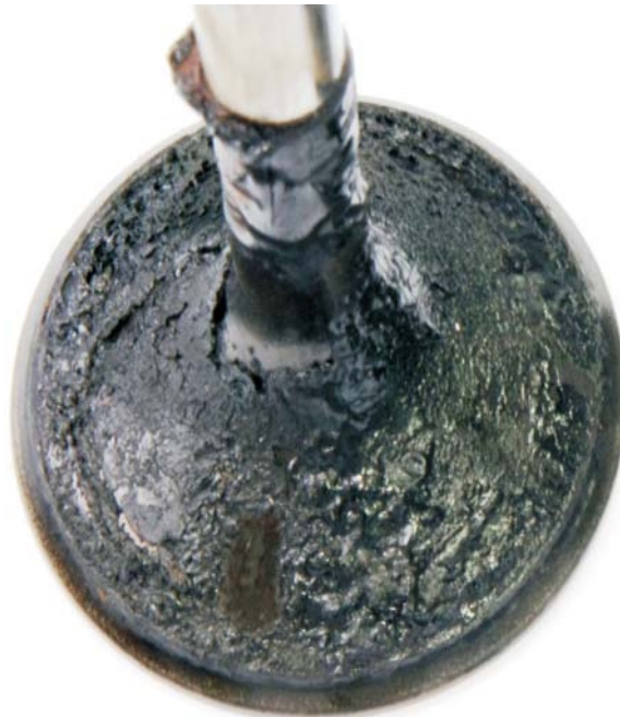
Rys. 7. Osady utworzone na powierzchni zaworu dolotowego z silnika zasilanego mieszaniną etyloowo-benzynową [3]
