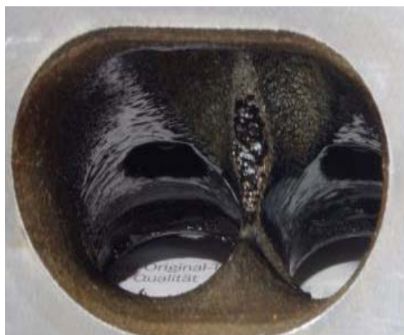
Rys.4. Osady utworzone w układzie dolotowym [3]
