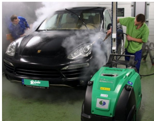
Rys.5. Proces mycia w myjni parowej [11]
