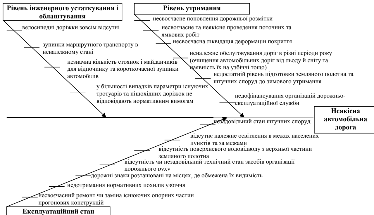
Рис. 3 - Причинно-наслідкові зв'язки між якісною автомобільною дорогою та факторами, які впливають на її якість
