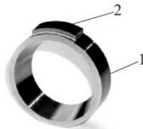
Rysunek 1 – Badana para cierna (1 – próbka pierścieniowa, 2 – przeciwpróbka)
