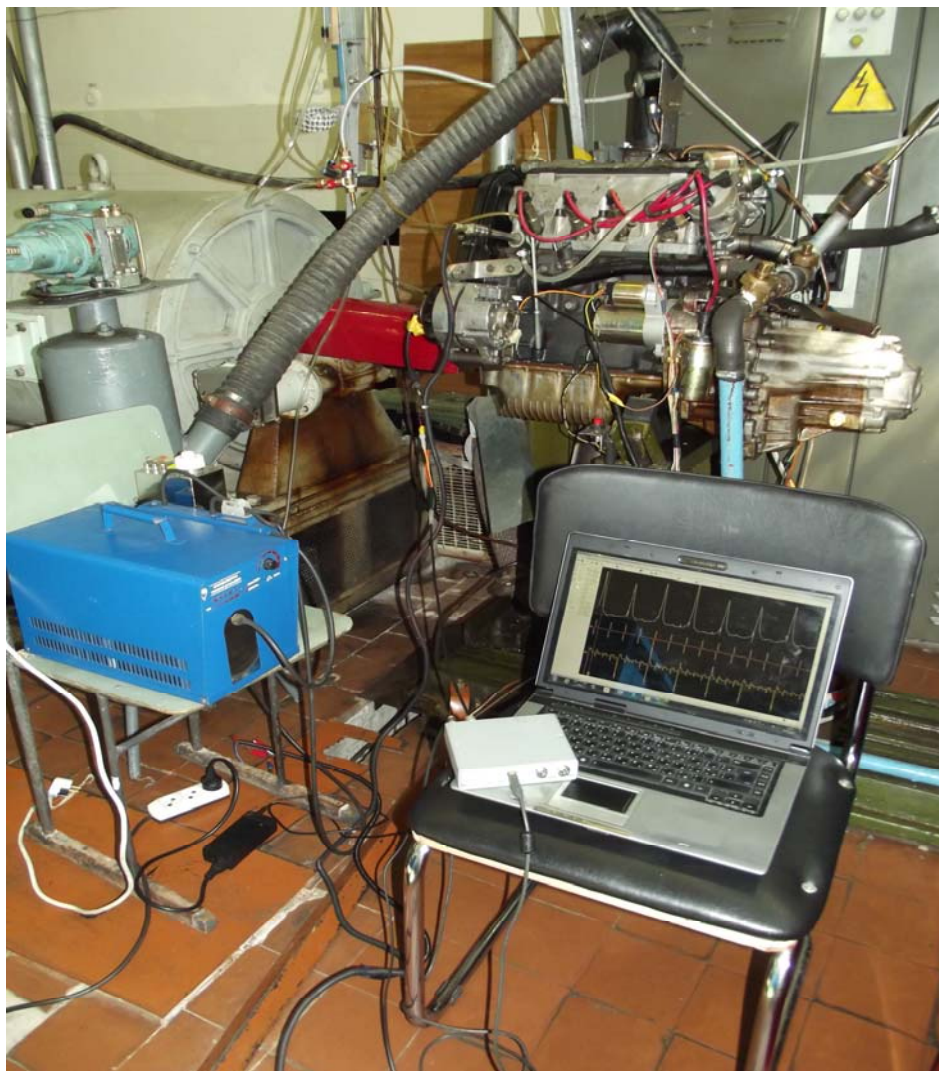
Рисунок 1 – Двигун MeM3-245 обладнаний вимірювальною апаратурою
