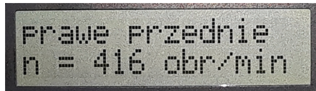
Rysunek 3 – Wyświetlacz LCD generatora sygnałów prędkości obrotowej kół układu ABS Figure 3 – LCD display of the ABS wheel speed signal generator
