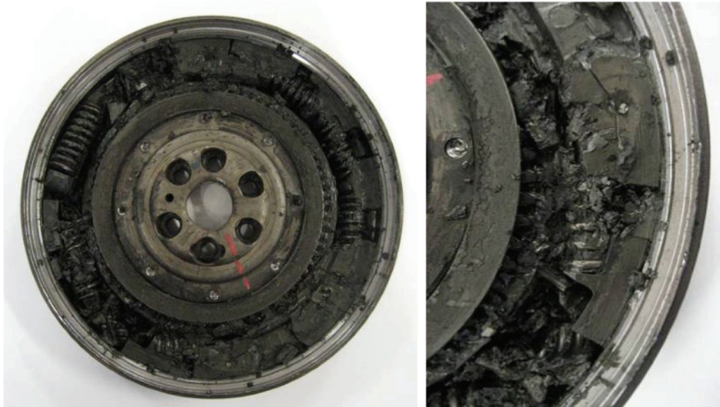
Рисунок 3 – Руйнування пружин всередині ДММ [6] Figure 3 – Destruction of the springs inside the DMF
