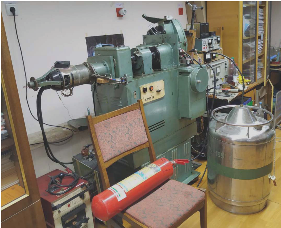
Рисунок 1 – Загальний вигляд триботехнічного комплексу СМЦ-2 з допоміжним обладнанням Figure 1 - General view of the tribotechnical complex (type SMC-2) with auxiliary equipment
