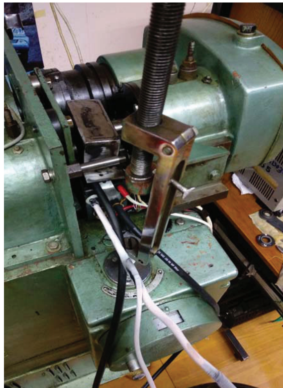
Рисунок 2 – Вузол тертя колодка-ролик із пристосуванням на машині тертя СМЦ-2 Figure 2 – Friction unit “tilting pad-roller” with adaptation on SMC-2 friction machine
