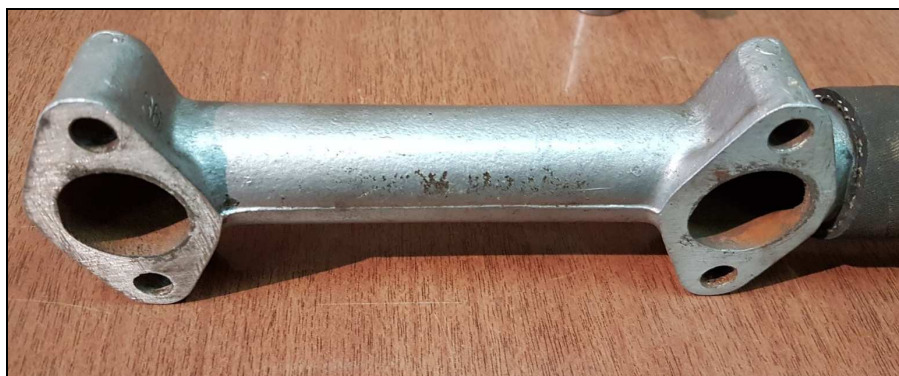
Rysunek 3 – Jeden z dwóch oryginalnych kolektorów układu chłodzenia
