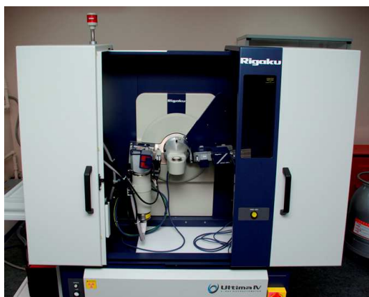
Рисунок 5 – Рентгенівський дифрактометр Rigaku Ultima IV Figure 5 – X-ray diffractometer Rigaku Ultima IV
