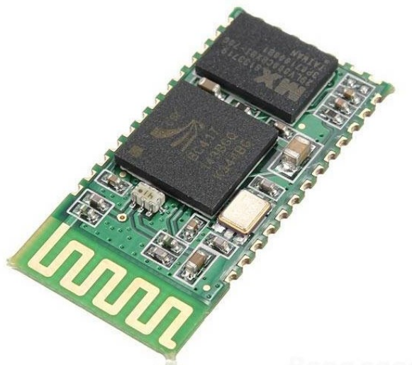
Рисунок 6 – Bluetooth модуль HC – 06 Figure 6 – Bluetooth module HC – 06
