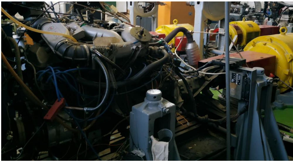
Рисунок 1 – Двигун Opel C30NE 3.0л встановлений на стапелі гальмівного стенду Figure 1 – Opel C30NE 3.0l engine mounted on the test bench
