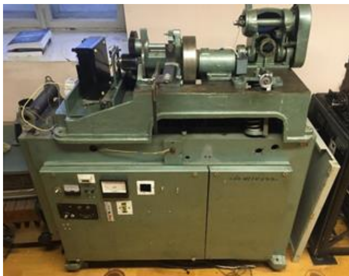
Рисунок 1 – Машина тертя МІ-1М Figure 1 – Machine rubbing MI-1M
