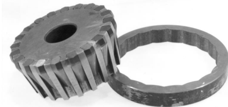
Рисунок 7 – Дослідний інструмент (зліва) та фрагмент зразка після індентування (дуралюмін Д16, справа)
