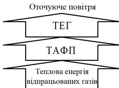
Рисунок 4 – Схема потоків теплової енергії в запропонованій термоелектричній системі утилізації частини теплової енергії ВГ з тепловим акумулятором фазового переходу Figure 4 – Scheme of thermal energy flows in the proposed thermoelectric system for utilization of part of the thermal energy of HV with a thermal accumulator phase transition
