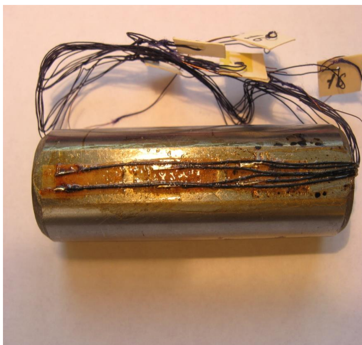
Рисунок 1 – Вісь сателіта з тензодатчиками Figure 1 – Satellite axis with strain gauges
