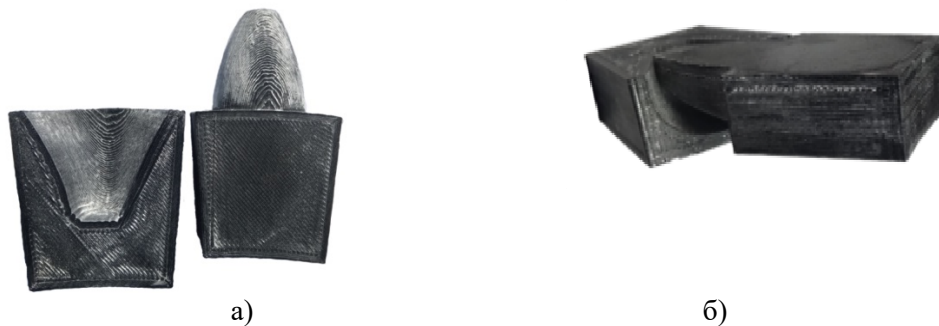
Рисунок 5 – Зображення надрукованих на 3d-принтері з пластику фрагменти зубзоакруглюючої впадини та торцевої поверхні зубця: а – деталі розміщені окремо; б – деталі знаходяться в зачепленні Figure 5 – Image of the fragments of the tooth-rounding cavity and end surface of the tooth printed on a 3d-printer from plastic: a – details are placed separately; b – the parts are engaged
