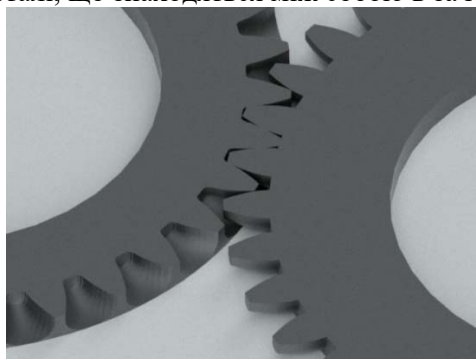
Рисунок 3 – Візуалізоване зображення 3d-моделі зубозаокруглюючого накатника та зубчастого вінця Figure 3 – A rendered image of a 3d model of a tooth-rounding knurling tool and gear ring
