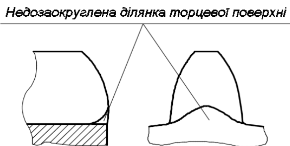
Рисунок 13 – Недозаокруглена торцева поверхня зуба Figure 13 – Underrounded end surface of the tooth
