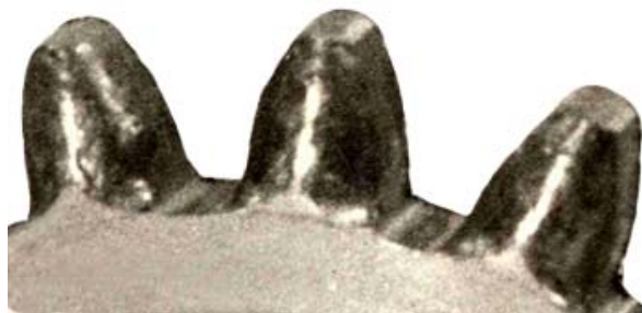
Рисунок 12 – Торцеві поверхні зубців бронзового зразка утворені при накатуванні накатником Figure 12 – The end surfaces of the teeth of the bronze sample were formed by rolling with a roller
