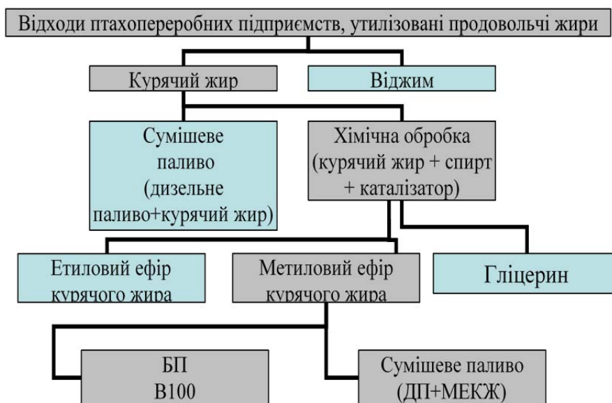
Рисунок 1 – Схема переробки відходів птахопереробних підприємств у біопаливо Figure 1 – Scheme of processing waste from poultry processing enterprises into biofuel
