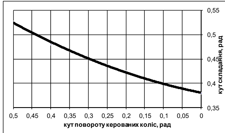
Рисунок 3 – Залежність кута складання ланок автопоїзда від кута повороту керованих коліс тягового автомобіля на початку його виходу з кругової траєкторії
