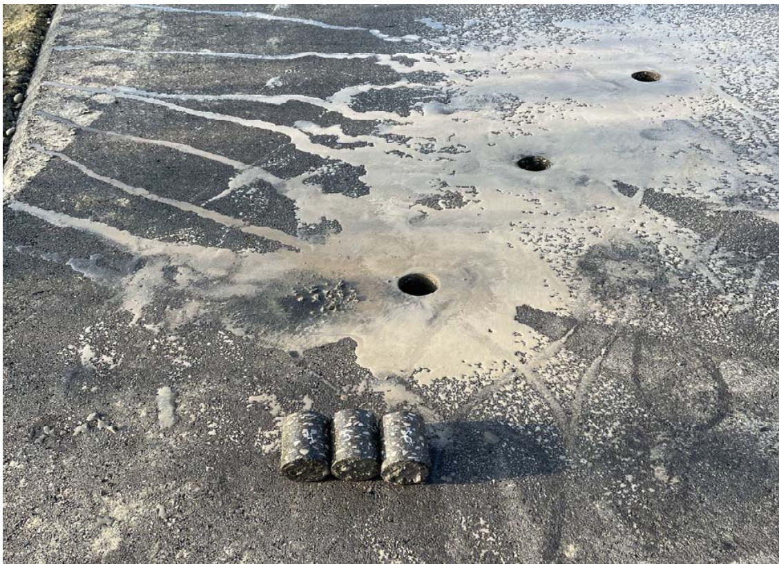
Рисунок 4 – Відібрані зразки-кernи на під'їзній автомобільній дорозі до прохідної 1-го блоку ДТЕК Бурштинської ТЕС Figure 4 – Selected core samples on the access road to the passageway of the 1st block of DTEK of the Burshtyn TPP
