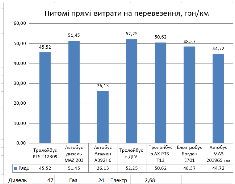
Рисунок 3 – Питомі прямі витрати на експлуатацію пасажирських КТЗ Figure 3 – Specific direct costs for passenger transport vehicles operation
