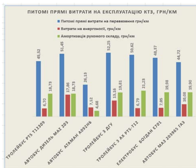
Рисунок 5 – Деякі суттєві складові собівартості експлуатації певних видів КТЗ Figure 5 – Some essential components of operation cost for certain vehicle types
