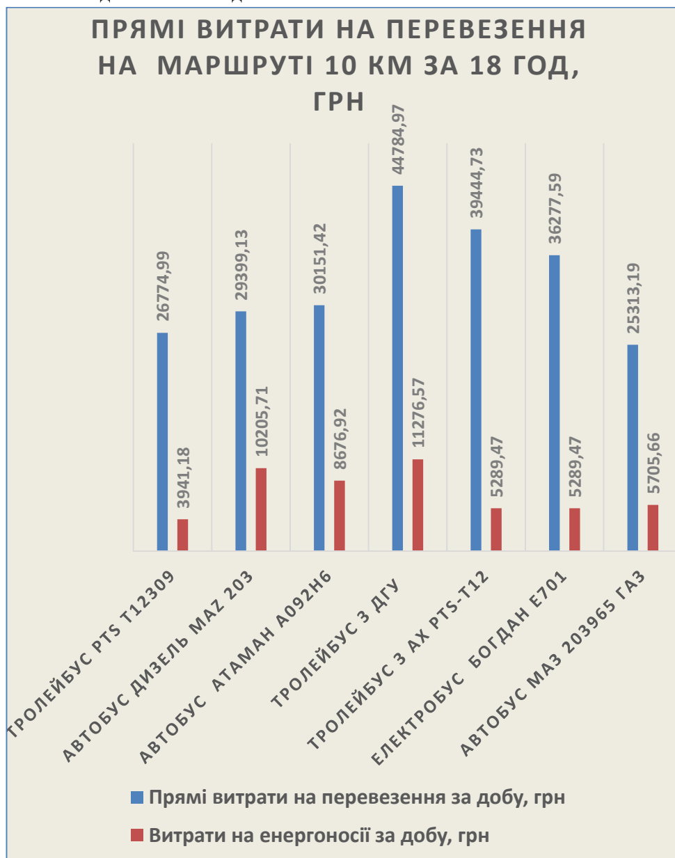
Рисунок 10 – Порівняння прямих витрат на експлуатацію ТЗ та на енергоносії для різних типів транспортних засобів на маршруті 10 км за добу Figure 10 – Comparison of direct vehicle operating costs and energy costs for different types of vehicles on a route of 10 km per day
