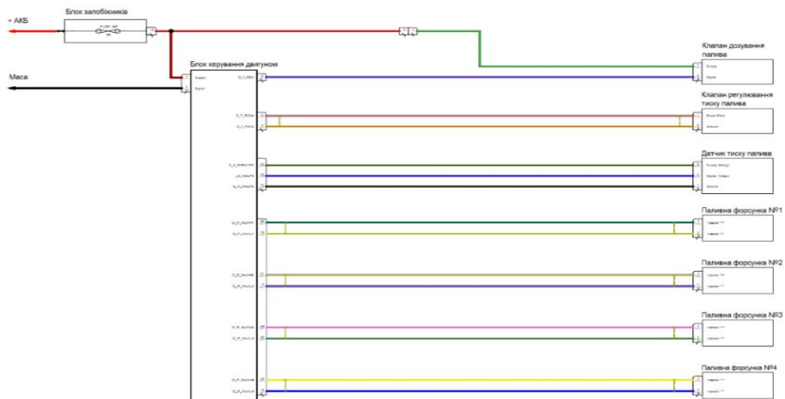
Рисунок 1 – Електрична схема паливної системи Bosch CRS2-25
