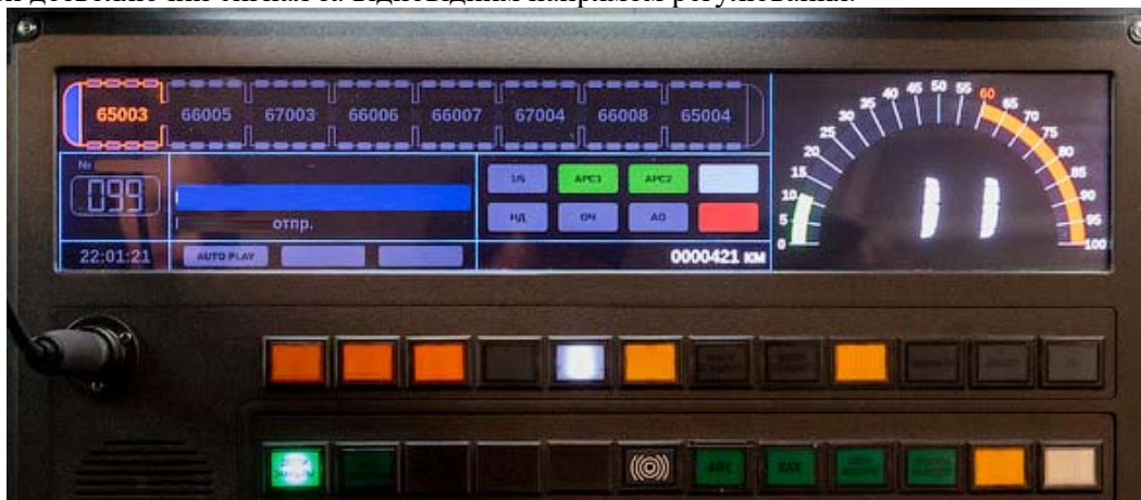
Рисунок 6 – Пульти керування машиніста метрополітену з системою АЛС-АРШ [15] Figure 6 – The subway driver's control panel with the ALS-ARS system [15]
